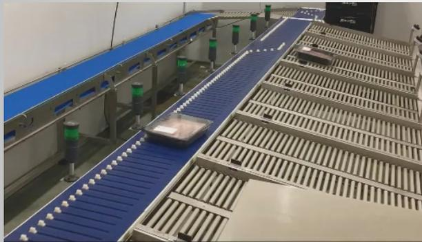
Le convoyeur AIM permet de faire de la preparation de commande.
