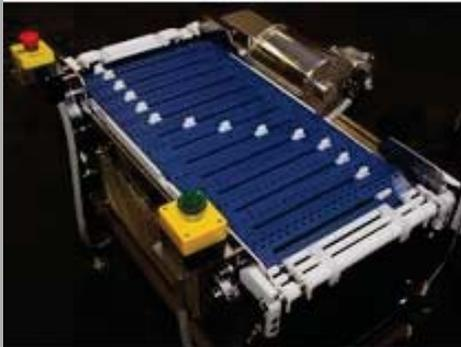
Voici notre nouvelle plateforme de solution AIM pour le transfert à 90° (éjection du produit), répartir ou regrouper à des vitesses de 60M/Min, avec des espaces entre produit de 100mm et une épaisseur très faible 2-3 mm.
