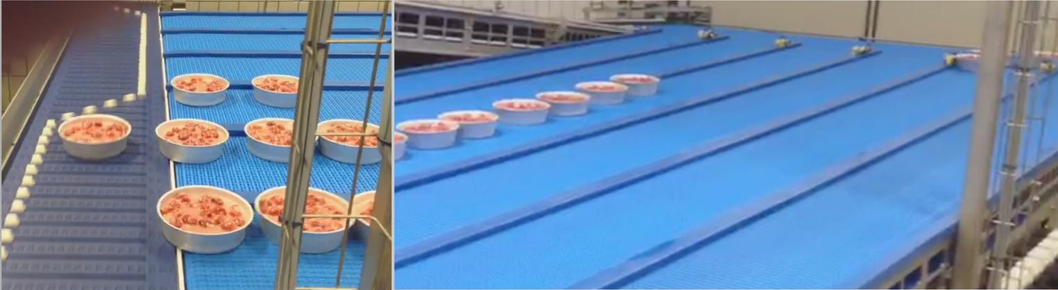
Le convoyeur AIM permet de charger une table d'accumulation.
