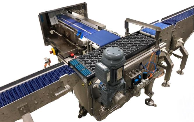
Les convoyeurs à transfert à 90° active de CIPAB permettent de résoudre efficacement les problèmes rencontrés sur les systèmes de transfert à 90° et les convoyeurs à rayon de courbure étroit traditionnels : positionnement incorrect des produits sur le tapis et problèmes de capteur engendrant des blocages, une mauvaise lecture des codes-barres, des ralentissements de ligne et des temps d'arrêt
